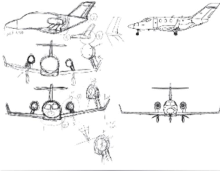
図 2-13 HondaJet オリジナルのコンセプトスケッチ(1997年頃)と側面図・正面図を対比
